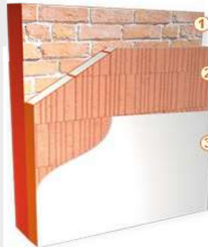
POROTON ® -WDF ® als Außendämmung
